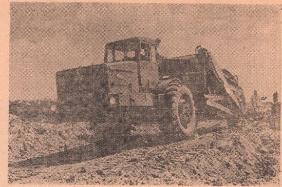
Украинская ССР. На николаевском заводе «Дормашин» построено самоходное скрепер «Д357Г» на базе нового минского автомобиля-тигана «МАЗ-529». Ковш скрепера емкостью 11 кубометров имеет ширину захвата грунта 2,78 метра.
