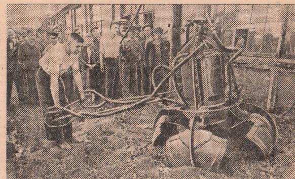
Кемеровская область. Кузнецкий машиностроительный завод освоил и выпускает «пневматический грузчик», широко применяемый при проходке
